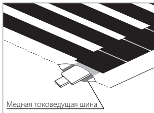
Рисунок 13. Правильная ориентация зажима (медная токопроводящая шина находится внизу).
