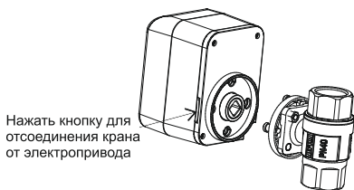
Способ фиксации арматуры (рис. 2)
